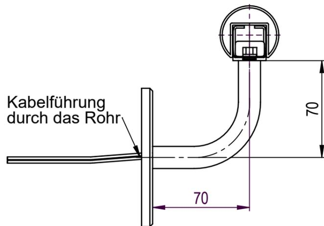
Kabelführung durch das Rohr
