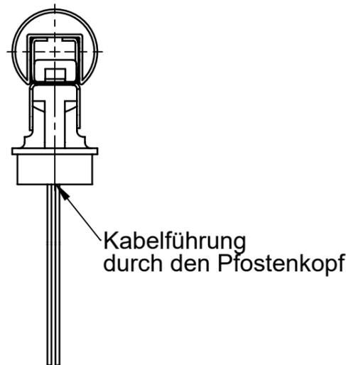
Kabelführung durch den Pfostenkopf
